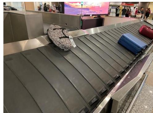
フィラデルフィア国際空港のバグゲージクレーンで 1 枚。よくよく見ると、クレーンからスーツケースが落ちてくる際、落下予定位置に荷物があるとセンサで検知している場合は、荷物が行き過ぎるまで待機していました。これも、社会ニーズにエンジニアリングが対応した例ですね、昔は上からトランク落ちてきてスーツケースにダメージ発生とかありましたし。（PE-0253 西久保 東功）
