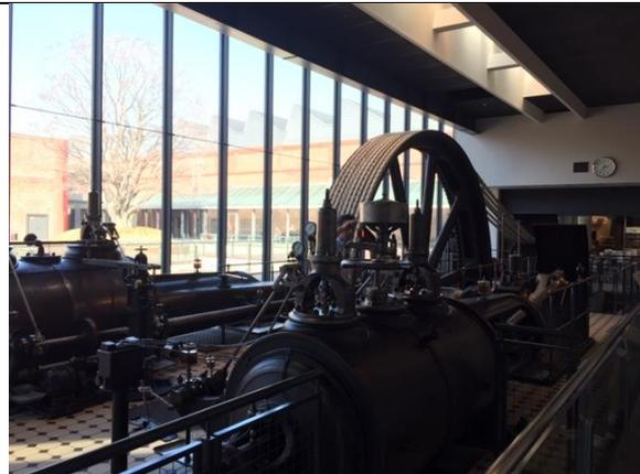
豊田産業技術博物館で、紡績工場を見学した際の一枚。1898年にスイスのスルザー社から導入したもので、高圧/低圧の2本のシリンダーと直径4.7mの巨大なフライホイールを備えており、9本のロープ伝動により発電機を回転させます。当時の現物が現在も稼働でき、当時の様子を現代の私たちに伝えてくれます。100年以上前の製品であるにもかかわらず現在も動き続けており、メンテナンスの重要性を改めて感じました。(PE-0253 西久保東功)
