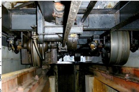
普通の鉄道では、線路の内側だけに淵がつき、線路に沿って走りますが、ケーブルカーは片側の車輪(溝車輪)がH字状に一方のレールを挟み込み、もう一方の車輪(平車輪)は厚みを確保しながら線路の上に「乗っている」だけのこと。その結果、ターンアウトにおいて2台の車両は、常に同じ側に進行し、車両同士が正面衝突しないように設計されています。シンプルなシステムほど信頼性が高くなる良い例だと感じました。
