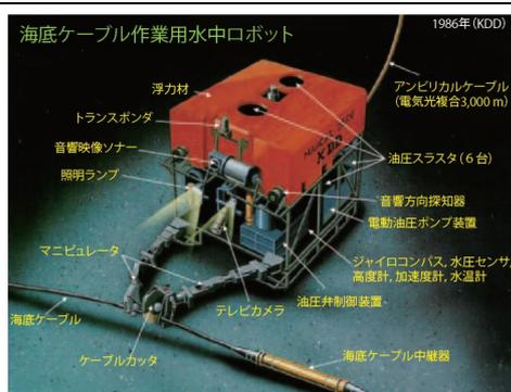
図3 大形深海作業用 ROV「MARCAS-2500」模式図
