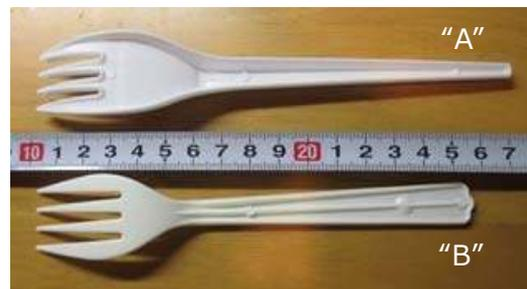
たわみの少ない理由の調査のため早速ノギスを購入。デジタルで最小読み取り長さ 0.1mm のものが 1,000 円ちょっとで手に入りました。私の手の大きさと握り方でフォークの支点となり箇所、先端から 80mm の箇所の断面寸法を測ってみました。下図の通りです。
